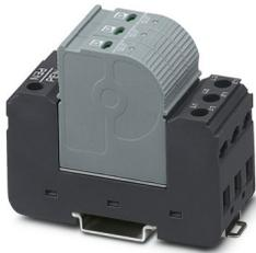
Descargador de sobretensiones enchufable para redes trifásicas de alimentación de corriente, con N y PE en un cable común (sistema de 4 conductores: L1, L2, L3, PEN), con contacto de indicación remota.
