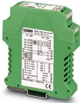
Convertidor de tensión MCR, para tensiones continuas de 0..(+/-)20 V DC hasta 0..(+/-)660 V DC, señal de salida (+/-)10 V/(+/-)20 mA
