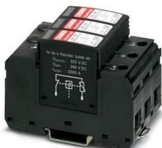
Dispositivo de protección contra sobretensiones para sistemas fotovoltaicos de tensión continua aislados y puestos a tierra de 600 V DC y 2 polos, para montaje sobre carril DIN, elemento de base de 3 polos, tres elementos de protección enchufables con monitorización de temperatura, mensaje de estado en cada conector.
