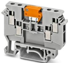
Borna interrumpible por cuchilla, tensión nominal: 630 V, corriente nominal: 16 A, tipo de conexión: Conexión por tornillo, sección: 0,2 mm<sup>2</sup> - 6 mm<sup>2</sup>, montaje: NS 32, NS 35/7,5, NS 35/15, color: gris
