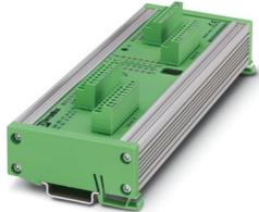
Módulo de acoplamiento (gateway), módulo de acoplamiento E/S para dos sistemas INTERBUS, 24 V DC, grado de protección IP20, con conexión de bus remoto MINI-COMBICON
