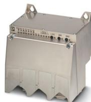
Controlador de arranque inversor electromecánico para INTERBUS; técnica de fibra óptica con 2 Mbaudios, entradas (24 V DC), relé guardamotor integrado (220 V AC hasta 480 V AC, máx. 8 A), conexión de sensor a través de conectores hembra M12 de 5 polos, robusta carcasa metálica, grado de protección IP67
