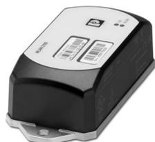
Punto de acceso WLAN, cliente para EE.UU. y Canadá, con 2 antenas internas para el montaje con un solo orificio, IP66/68, WLAN 802.11 a, b, g, n, frecuencia: 2,4 GHz, 5 GHz, conexiones: COMBICON 9 ... 32 V DC, RJ45: para LAN, web, http/https, CLI
