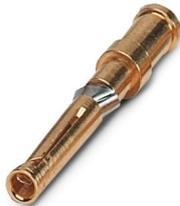
Contacto crimpado, serie: HC-M-12, Hembra, mecanizado, diámetro de contacto: 1,6 mm, sección de conexión: 2,5 mm<sup>2</sup> ... 2,5 mm<sup>2</sup>, AWG 14...14 , material contacto: Aleación de Cu
