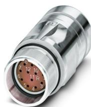
M23, Conector de acoplamiento, serie: CA, recto, apantallado: sí, para bloqueo estándar y SPEEDCON, N° de polos: 12, Sentido de giro: Estándar, tipo de conexión del contacto: Hembra, Conexión crimpada, rango de diámetro de cable: 6 mm ... 10 mm, codificación: N, se espera que este artículo no contenga plomo a partir del primer trimestre de 2026 de acuerdo con RoHS II sin excepción 6c (Pb <0,1 %), una alternativa sin plomo está disponible previamente a petición
