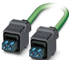
Cable de fibra óptica PROFINET confeccionado, cable redondo, fibra de polímero 980/1000  $\mu\text{m}$ , SC-RJ/IP67 push-pull carcasa de plástico a SC-RJ/IP67 push-pull, carcasa de plástico, para la colocación en el interior de edificios, cable adecuado para el uso en exteriores con protección UV, longitud: 1 m
