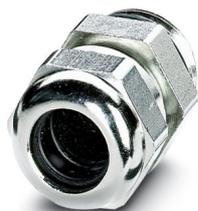
Prensaestopas, material conexión por tornillo: Latón, niquelado, diámetro exterior del cable 6,5 mm ... 9,5 mm, apantallamiento: no, rosca de conexión: M16 x 1,5, serie: RM
