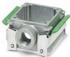
DUPLICON, carcasa apilable en aluminio para insertos de contactos DUPLICON, construcción B6, grado de protección IP67, con dos bridas de bloqueo, junta y una rosca para prensaestopas M25 (sin prensaestopas)
