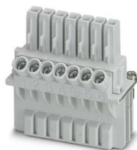
DUPLICON, inserto de contactos para conector enchufable, 6 x 4 mm<sup>2</sup> + PE, 400/690 V, 25 A, conexión por tornillo, construcción B6, grado de protección IP20
