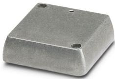
DUPLICON, tapa de carcasa en aluminio, construcción B6, grado de protección IP67, con dos tornillos M3, V2A, dispuestos de forma imperdible, junta y taladro para cordón de retención, para tornillo autorroscante M3
