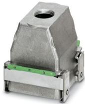
DUPLICON, carcasa apilable en aluminio para insertos de contactos DUPLICON, construcción B6, grado de protección IP67, con dos bridas de bloqueo, junta y roscas para prensaestopas M25 (sin prensaestopas), salida recta
