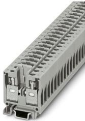
Borna seccionable, La corriente y la tensión son determinadas por el conector empleado., tensión nominal: 500 V, corriente nominal: 16 A, tipo de conexión: Conexión por tornillo, Sección de dimensionamiento: 4 mm<sup>2</sup>, sección: 0,2 mm<sup>2</sup> - 4 mm<sup>2</sup>, montaje: NS 15, color: gris
