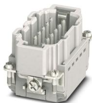
Inserto de contactos, número de polos: 10+PE, tamaño: B10, número de conexiones por polo: 1, Macho, Conexión push-in, 500 V, 16 A, 0,14 mm<sup>2</sup> ... 2,5 mm<sup>2</sup>, aplicación: Potencia
