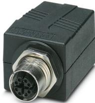
Pasamuros de armario de control, M12, 8 polos, codificado X a conector hembra RJ45, entrada hembra 180°, IP65/67
