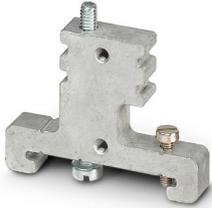
Soporte final, para el apoyo de los bornes, para montaje sobre carril NS 32 o NS 35/7,5, material: aluminio, anchura: 8 mm
