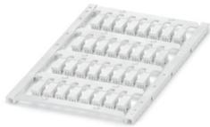
Marcador de conductores, Estera, disponible: por esteras, blanco, rotulado según las indicaciones del cliente, rango de diámetro de cable: 2 ... 2,9 mm, clase de montaje: enganchar, Número de índices individuales: 32, altura del campo de texto: 4 mm, anchura del campo de texto: 12 mm
