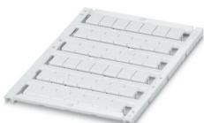
Marcador para bornes, Estera, blanco, sin rotular, rotulable con: BLUEMARK E.CARD, BLUEMARK ID COLOR, BLUEMARK ID, BLUEMARK CLED, THERMOMARK PRIME 2.0, THERMOMARK PRIME, THERMOMARK CARD 2.0, THERMOMARK CARD, TOPMARK NEO, TOPMARK LASER, clase de montaje: enclavar, para ancho de borne: 8,2 mm, Número de índices individuales: 42, altura del campo de texto: 10,5 mm, anchura del campo de texto: 7,6 mm
