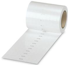
Rótulo insertable, Rollo, blanco, sin rotular, rotulable con: THERMOMARK E.300 (D)/600 (D), THERMOMARK ROLL 2.0, THERMOMARK ROLL, THERMOMARK ROLL X1, THERMOMARK ROLLMASTER 300/600, THERMOMARK X1.2, rango de diámetro de cable: 0,6 ... 7 mm, clase de montaje: introducir, Número de índices individuales: 7500, altura del campo de texto: 4 mm, anchura del campo de texto: 10 mm
