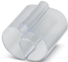
Soporte para señalización de conductores, transparente, sin rotular, rango de diámetro de cable: 14 ... 22 mm, clase de montaje: deslizamiento, altura del campo de texto: 4 mm, anchura del campo de texto: 23 mm
