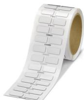
Etiqueta, Rollo, blanco, sin rotular, rotulable con: THERMOMARK E.300 (D)/600 (D), THERMOMARK ROLL 2.0, THERMOMARK ROLL, THERMOMARK ROLL X1, THERMOMARK ROLLMASTER 300/600, THERMOMARK X1.2, clase de montaje: pegado, Número de índices individuales: 500, altura del campo de texto: 12,5 mm, anchura del campo de texto: 27 mm
