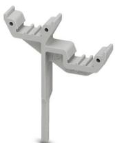
Soporte para señalización, Insertable en la borna de conexión por resorte de doble piso STTB 2,5, STTB 4, PTTB 2,5, PTTB 4, rotulable con UC-TM 5, UC-TMF 5, UCT-TM 5, UCT-TMF 5, ZB 5 o ZBF 5, gris, sin rotular, clase de montaje: enchufar, altura del campo de texto: 10,5 mm, anchura del campo de texto: 5 mm
