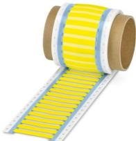
Manguito termorretráctil, Rollo, amarillo, sin rotular, rotulable con: THERMOMARK E.300 (D)/600 (D), THERMOMARK ROLLMASTER 300/600, THERMOMARK ROLL X1, THERMOMARK ROLL, THERMOMARK ROLL 2.0, THERMOMARK W, THERMOMARK X1.2, rango de diámetro de cable: 1,6 ... 4,8 mm, Perforado, clase de montaje: deslizamiento, Número de índices individuales: 500, altura del campo de texto: 9 mm, anchura del campo de texto: 30 mm
