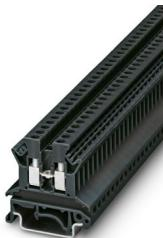
Borne de paso, tensión nominal: 800 V, corriente nominal: 24 A, número de conexiones: 2, tipo de conexión: Conexión por tornillo, Sección de dimensionamiento: 2,5 mm<sup>2</sup>, sección: 0,2 mm<sup>2</sup> - 4 mm<sup>2</sup>, clase de montaje: NS 35/7,5, NS 35/15, NS 32, color: negro
