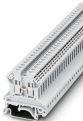
Borne de paso, tensión nominal: 800 V, corriente nominal: 24 A, número de conexiones: 2, tipo de conexión: Conexión por tornillo, Sección de dimensionamiento: 2,5 mm<sup>2</sup>, sección: 0,2 mm<sup>2</sup> - 4 mm<sup>2</sup>, clase de montaje: NS 35/7,5, NS 35/15, NS 32, color: blanco
