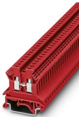
Borne de paso, tensión nominal: 800 V, corriente nominal: 24 A, número de conexiones: 2, tipo de conexión: Conexión por tornillo, Sección de dimensionamiento: 2,5 mm<sup>2</sup>, sección: 0,2 mm<sup>2</sup> - 4 mm<sup>2</sup>, clase de montaje: NS 35/7,5, NS 35/15, NS 32, color: rojo
