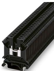
Borne de paso, tensión nominal: 800 V, corriente nominal: 32 A, número de conexiones: 2, tipo de conexión: Conexión por tornillo, Sección de dimensionamiento: 4 mm<sup>2</sup>, sección: 0,2 mm<sup>2</sup> - 6 mm<sup>2</sup>, clase de montaje: NS 35/7,5, NS 35/15, NS 32, color: negro
