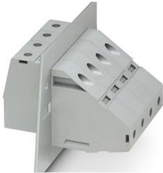
Borne de paso, tipo de conexión: Conexión por tornillo con cápsula de tracción, Conexión por tornillo con cápsula de tracción, número de polos: 1, corriente de carga: 232 A, sección: 25 mm<sup>2</sup> - 95 mm<sup>2</sup>, dirección de conexión del conductor con respecto a la dirección de enchufe: -90 °, anchura: 25 mm, color: gris
