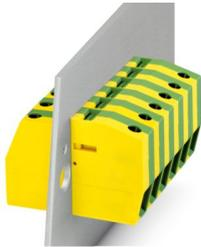
Borne de paso, tipo de conexión: Conexión por tornillo con cápsula de tracción, Conexión por tornillo con cápsula de tracción, número de polos: 1, corriente de carga: 101 A, sección: 6 mm<sup>2</sup> - 35 mm<sup>2</sup>, dirección de conexión del conductor con respecto a la dirección de enchufe: 0 °, anchura: 15,1 mm, color: verde-amarillo
