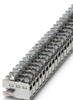
Módulo de ramificación, corriente nominal: 125 A, tipo de conexión: Conexión por tornillo, Sección de dimensionamiento: 35 mm<sup>2</sup>, sección: 0,75 mm<sup>2</sup> - 35 mm<sup>2</sup>, montaje: Barra colectora del neutro, color: color aluminio
