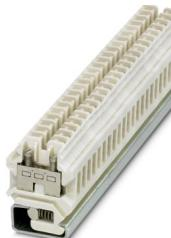
Borne de paso, tipo de conexión: conexión por tornillo, sección: 0,5 mm<sup>2</sup> - 10 mm<sup>2</sup>, AWG 20 - 8, ancho: 8,4 mm, color: blanco, tipo de montaje: NS 32, material de aislamiento: cerámica
