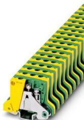
Borna de tierra, En una alineación conjunta con borne de paso de igual contorno, debe utilizarse una placa separadora de zonas para tensiones de aislamiento > 250 V, número de conexiones: 2, tipo de conexión: Conexión por tornillo, 1er piso, sección: 0,2 mm<sup>2</sup> - 4 mm<sup>2</sup>, tipo de sujeción: Pie PE con tornillo de fijación, M2,5, clase de montaje: NS 15, color: amarillo-verde
