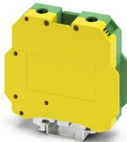
Borna de tierra, número de conexiones: 2, número de polos: 1, tipo de conexión: Conexión por tornillo, Sección de dimensionamiento: 50 mm<sup>2</sup>, sección: 16 mm<sup>2</sup> - 50 mm<sup>2</sup>, tipo de sujeción: Pie PE con tornillo de fijación, M6, clase de montaje: NS 35/7,5, NS 35/15, NS 32, color: amarillo-verde
