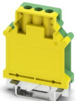
Borna de tierra, En una alineación conjunta con bornes de paso de igual contorno, hay que insertar una tapa para tensiones de aislamiento > 690 V., número de conexiones: 2, número de polos: 1, tipo de conexión: Conexión por tornillo, Sección de dimensionamiento: 16 mm<sup>2</sup>, sección: 2,5 mm<sup>2</sup> - 25 mm<sup>2</sup>, tipo de sujeción: Pie PE con tornillo de fijación, M4, clase de montaje: NS 35/7,5, NS 35/15, NS 32, color: amarillo-verde
