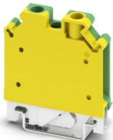
Borna de tierra, número de conexiones: 2, número de polos: 1, tipo de conexión: Conexión por tornillo, sección: 0,2 mm<sup>2</sup> - 10 mm<sup>2</sup>, tipo de sujeción: Pie PE con tornillo de fijación, M4, clase de montaje: NS 35/7,5, NS 35/15, NS 32, color: amarillo-verde
