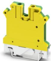
Borna de tierra, En una alineación conjunta con bornes de paso de igual contorno, hay que insertar una tapa para tensiones de aislamiento > 690 V., número de conexiones: 2, tipo de conexión: Conexión por tornillo, Sección de dimensionamiento: 4 mm<sup>2</sup>, sección: 0,2 mm<sup>2</sup> - 6 mm<sup>2</sup>, tipo de sujeción: Pie PE con tornillo de fijación, M3, clase de montaje: NS 35/7,5, NS 35/15, NS 32, color: amarillo-verde
