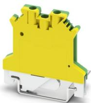
Borna de tierra, número de conexiones: 2, número de polos: 1, tipo de conexión: Conexión por tornillo, sección: 0,2 mm<sup>2</sup> - 4 mm<sup>2</sup>, tipo de sujeción: Pie PE con tornillo de fijación, M2,5, clase de montaje: NS 35/7,5, NS 35/15, NS 32, color: amarillo-verde
