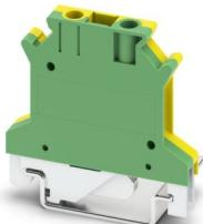
Borna de tierra, número de conexiones: 2, número de polos: 1, tipo de conexión: Conexión por tornillo, sección: 0,2 mm<sup>2</sup> - 4 mm<sup>2</sup>, tipo de sujeción: Pie PE con tornillo de fijación, M3, clase de montaje: NS 35/7,5, NS 35/15, NS 32, color: amarillo-verde
