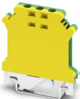
Borna de tierra, En una alineación conjunta con bornes de paso de igual contorno, hay que insertar una tapa para tensiones de aislamiento > 690 V., número de conexiones: 2, número de polos: 1, tipo de conexión: Conexión por tornillo, Sección de dimensionamiento: 4 mm<sup>2</sup>, sección: 0,2 mm<sup>2</sup> - 4 mm<sup>2</sup>, clase de montaje: NS 35/7,5, NS 35/15, NS 32, color: amarillo-verde
