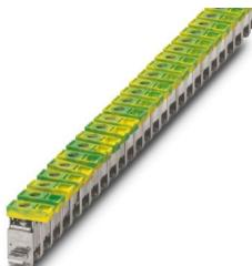
Borna de conexión, tensión nominal: 300 V, corriente nominal: 125 A, tipo de conexión: Conexión por tornillo, Sección de dimensionamiento: 35 mm<sup>2</sup>, sección: 2,5 mm<sup>2</sup> - 35 mm<sup>2</sup>, montaje: Barra colectora del neutro, color: amarillo-verde
