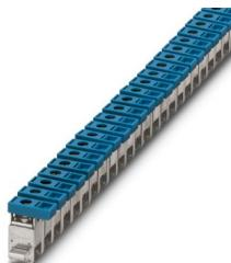
Borna de conexión, tensión nominal: 300 V, corriente nominal: 125 A, tipo de conexión: Conexión por tornillo, Sección de dimensionamiento: 35 mm<sup>2</sup>, sección: 2,5 mm<sup>2</sup> - 35 mm<sup>2</sup>, montaje: Barra colectora del neutro, color: azul
