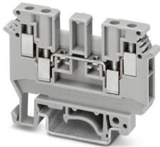
Borne de paso, tensión nominal: 630 V, corriente nominal: 32 A, número de conexiones: 4, número de polos: 1, tipo de conexión: Conexión por tornillo, Sección de dimensionamiento: 4 mm<sup>2</sup>, sección: 0,2 mm<sup>2</sup> - 6 mm<sup>2</sup>, clase de montaje: NS 35/7,5, NS 35/15, NS 32, color: gris
