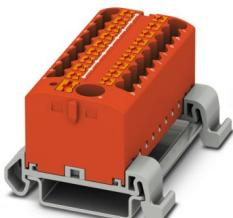
Verteilerblock, Block mit waagerechter Ausrichtung und integrierter Einspeisung, Nennspannung: 690 V, Nennstrom: 24 A, Anzahl der Anschlüsse: 19, Anschlussart: Push-in-Anschluss, Bemessungsquerschnitt: 2,5 mm<sup>2</sup>, Abgriff, Querschnitt: 0,14 mm<sup>2</sup> - 4 mm<sup>2</sup>, Push-in-Anschluss, Sammelanschluss, Bemessungsquerschnitt: 6 mm<sup>2</sup>, Querschnitt: 0,5 mm<sup>2</sup> - 10 mm<sup>2</sup>, Montageart: NS 35/7,5, NS 35/15, Farbe: rot
