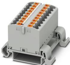
Verteilerblock, Block mit waagerechter Ausrichtung, Nennspannung: 690 V, Nennstrom: 24 A, Anzahl der Anschlüsse: 18, Anschlussart: Push-in-Anschluss, Querschnitt: 0,14 mm<sup>2</sup> - 4 mm<sup>2</sup>, Montageart: NS 35/7,5, NS 35/15, Farbe: grau
