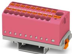
Verteilerblock, Block mit senkrechter Ausrichtung und integrierter Einspeisung, Nennspannung: 690 V, Nennstrom: 24 A, Anzahl der Anschlüsse: 19, Anschlussart: Push-in-Anschluss, Bemessungsquerschnitt: 2,5 mm<sup>2</sup>, Abgriff, Querschnitt: 0,14 mm<sup>2</sup> - 4 mm<sup>2</sup>, Push-in-Anschluss, Sammelanschluss, Bemessungsquerschnitt: 6 mm<sup>2</sup>, Querschnitt: 0,5 mm<sup>2</sup> - 10 mm<sup>2</sup>, Montageart: NS 35/7,5, NS 35/15, Farbe: pink
