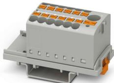
Verteilerblock, Block mit senkrechter Ausrichtung und integrierter Einspeisung, Nennspannung: 690 V, Nennstrom: 24 A, Anzahl der Anschlüsse: 13, Anschlussart: Push-in-Anschluss, Bemessungsquerschnitt: 2,5 mm<sup>2</sup>, Abgriff, Querschnitt: 0,14 mm<sup>2</sup> - 4 mm<sup>2</sup>, Push-in-Anschluss, Sammelanschluss, Bemessungsquerschnitt: 6 mm<sup>2</sup>, Querschnitt: 0,5 mm<sup>2</sup> - 10 mm<sup>2</sup>, Montageart: NS 35/7,5, NS 35/15, Farbe: grau
