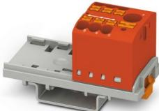
Verteilerblock, Block mit senkrechter Ausrichtung und integrierter Einspeisung, Nennspannung: 690 V, Nennstrom: 24 A, Anzahl der Anschlüsse: 7, Anschlussart: Push-in-Anschluss, Bemessungsquerschnitt: 2,5 mm<sup>2</sup>, Abgriff, Querschnitt: 0,14 mm<sup>2</sup> - 4 mm<sup>2</sup>, Push-in-Anschluss, Sammelanschluss, Bemessungsquerschnitt: 6 mm<sup>2</sup>, Querschnitt: 0,5 mm<sup>2</sup> - 10 mm<sup>2</sup>, Montageart: NS 35/7,5, NS 35/15, Farbe: rot
