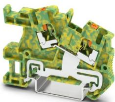
Installations-Schutzleiterklemme, Push-in-Anschluss, 1. Etage, Querschnitt: 0,14 mm<sup>2</sup> - 4 mm<sup>2</sup>, Montageart: NS 35/7,5, NS 35/15, Farbe: grün-gelb
