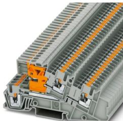
Installationsetagenklemme, Nennspannung: 400 V, Nennstrom: 24 A, Push-in-Anschluss, 1., 2. und 3. Etage, Bemessungsquerschnitt: 2,5 mm<sup>2</sup>, Querschnitt: 0,14 mm<sup>2</sup> - 4 mm<sup>2</sup>, Push-in-Anschluss, Montageart: NS 35/7,5, NS 35/15, Farbe: grau
